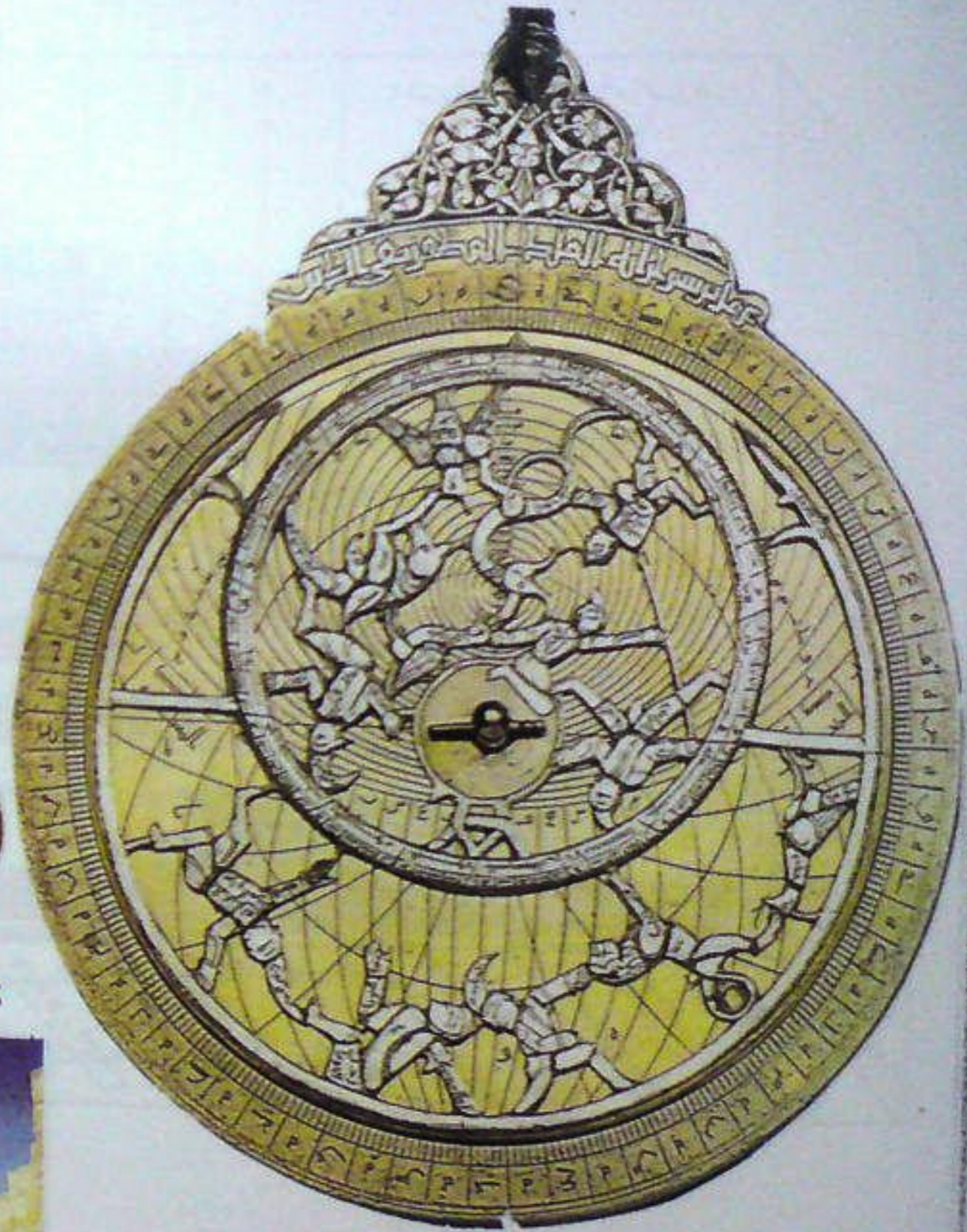
- الاسطرلاب : صنع السهل إيسابوري في مدينة حماة عام ٦٩٨ هـ / ١٢٩٨ م . وهو آلة قديمة لقياس ارتفاعات الأجرام السماوية ويحمل مقياس الكرة السماوية على سطح مستو وعليه فرائط للقياس والبروج
